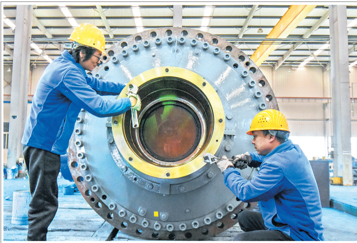
日前,荆州市巨鲸传动机械有限公司生产车间内,工人在给一款XG系列减速机用行星减速机进行出厂前检测。
