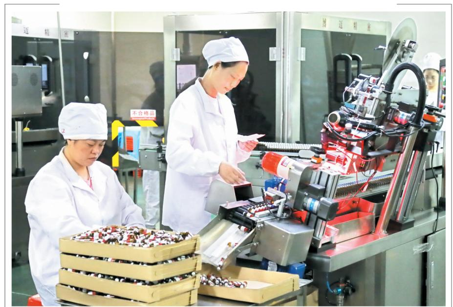
日前,东信药业员工利用全自动高灵敏度灯检设备对产品内在可见异物进行检查。湖北东信药业有限公司视产品质量为企业生命线,根据生产发展需要,在不断完善产品质量保证体系的同时,加大产品质量检测设备投入,加强对生产过程产品质量监控力度,确保产品质量安全可控。
