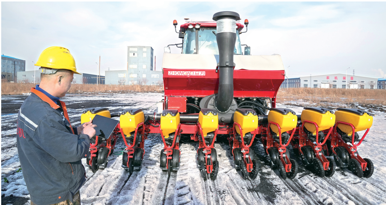
在黑龙江省众为农机有限公司，工作人员测试一款高速风吸吹电驱播种机的控制系统(2024年3月13日报)。（新华社 发）
