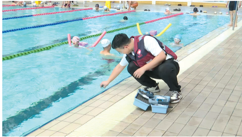
工作人员对泳池水的游离性余氯进行现场快速检测。
