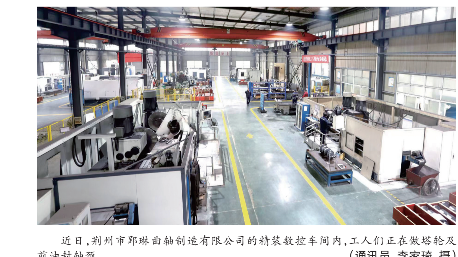
近日,荆州市鄂琳曲轴制造有限公司的精装数控车间内,工人们正在做塔轮及前油封轴端。(通讯员 李家琦 摄)
