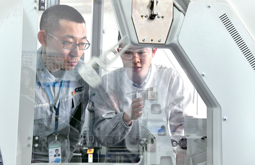
在烟台万华化学集团中央研究院，工作人员在做聚丙烯材料摆锤冲击试验（2019年4月30日摄）。与中国改革开放同龄的万华化学集团股份有限公司走出一条令人瞩目的中国特色现代国有企业改革发展之路。（新华社 发）
