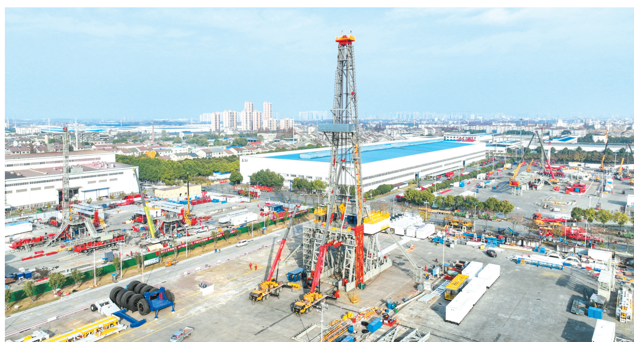
中国石化机械四机公司发往科威特的首台9000米超深井钻机顺利起升。(通讯员 李国荣 摄)
