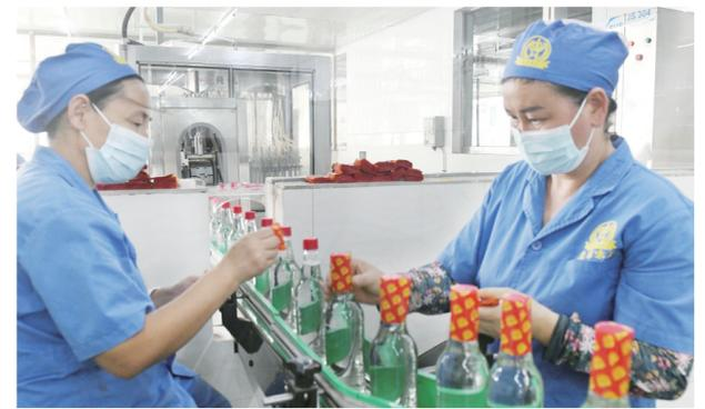
近日，在位于沙市区锣场镇的荆州市皇冠调味品有限公司生产车间内，工人们正全神贯注地进行食醋灌装、封口、贴标、检验等工序。
