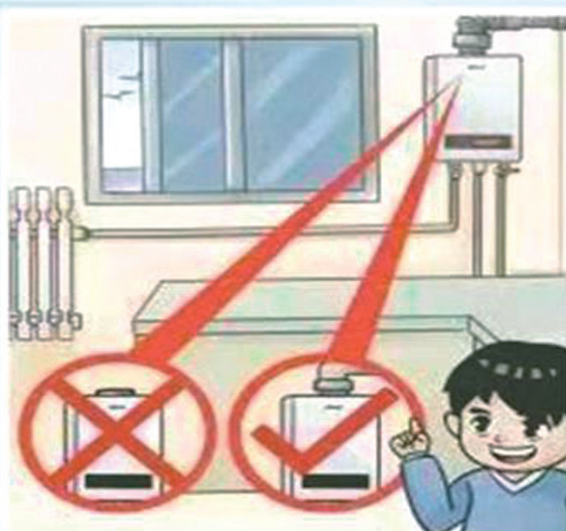
正确安装使用燃气炉、 热水器，保证通风和换气
